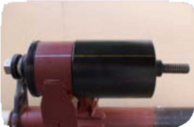
Fig. 14 - Position correcte du liner avec le bras de suspension
