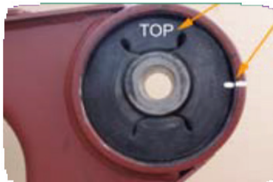
Fig. 17 - Vérification du montage correct
