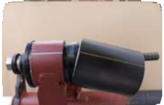
Fig. 15 - Baisse du liner
