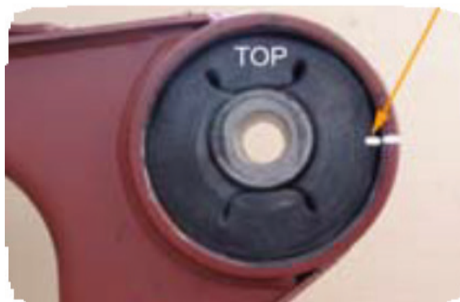
Fig. 4 - Gros plan sur la position de rétraction du silentblock
