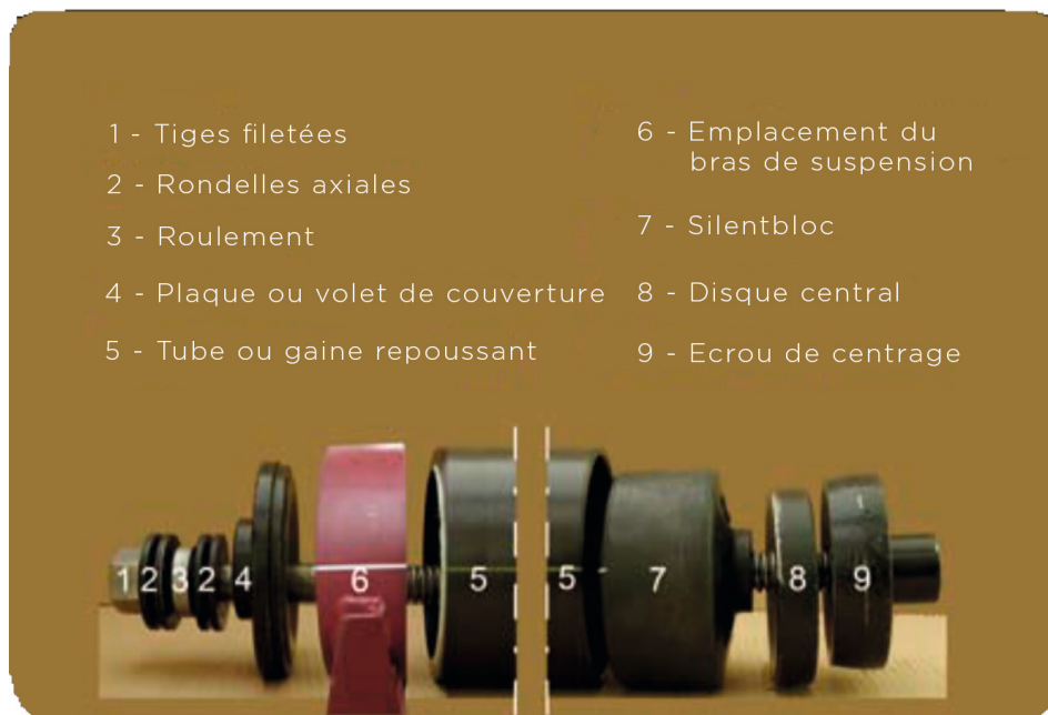
Fig. 7 - Position de montage de l'outil d'installation (vue déformée pour une meilleure illustration)
