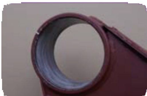
Fig. 9 - Lubrification du boîtier du silentblock
